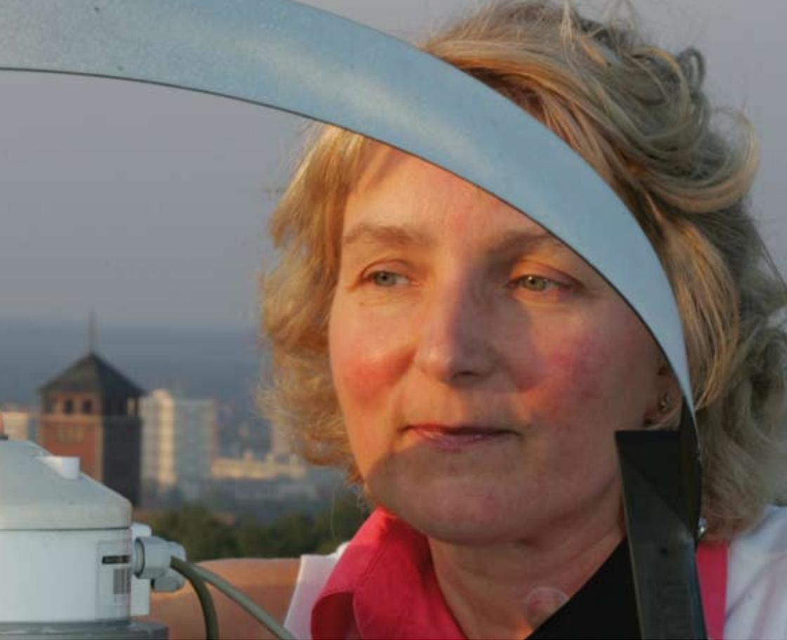
Die Messung der diffusen Sonnenstrahlung erfolgt ebenfalls mit einem Pyranometer, das zum Ausblenden der Sonne mit einem Schattenring ausgerüstet ist. Dieser Schattenring deckt jedoch je nach Jahreszeit einen mehr oder weniger großen Streifen des Himmels ab. Deshalb werden die Messwerte nachträglich mit Hilfe eines geeigneten Verfahrens korrigiert. Bei guter Wartung ist die Messunsicherheit eines Pyranometers kleiner als 3 %.
